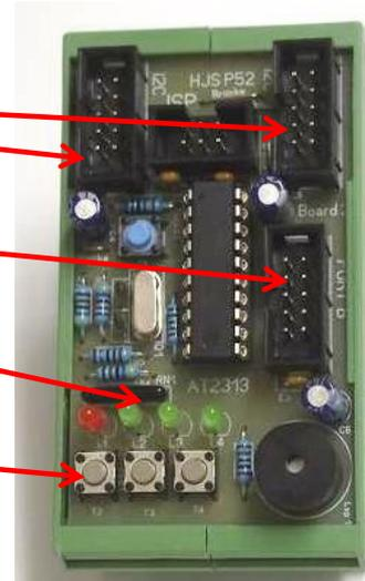
**Bedienung:** Taster **T2** schaltet **LED 2** ein oder aus
