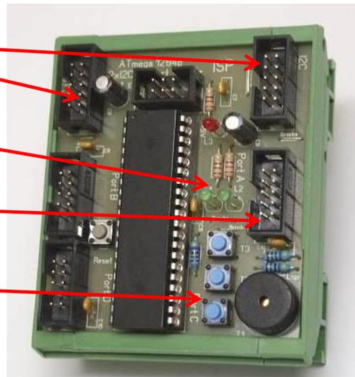
Es kann sowohl ein Slave mit einem Prozessor z.B. Attiny 2313 (mit USI) oder andere Module mit I<sup>2</sup>C Bus IC's angeschlossen werden. Den Anschluss mehrerer Slave mit Prozessor habe ich nicht getestet. Am Port A können weitere LEDs angeschlossen werden.
