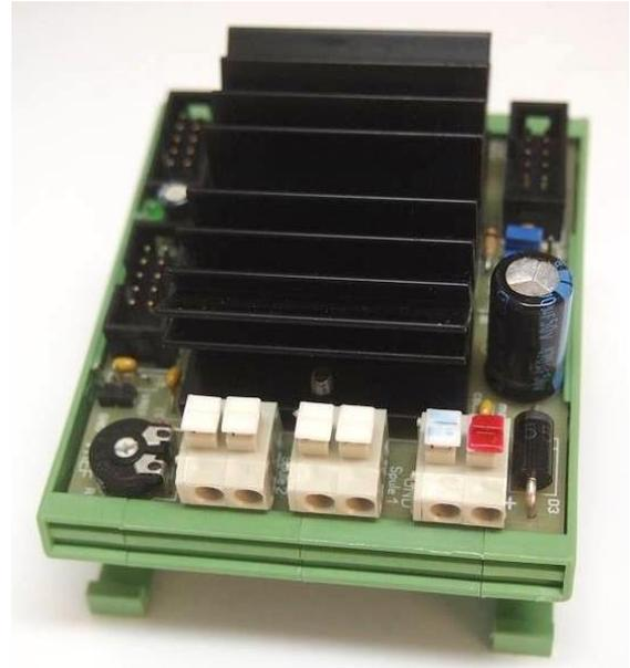
Die genauen Anschlüsse für die +24V und den beiden Spulen habe ich im 2. Teil bereits genau beschrieben. Bitte nicht vergessen die **V<sub>REF</sub>** auszurechnen und einzustellen. Zum ersten Test habe ich ein kleines Programm geschrieben. Alle Anschlüsse, Pins und Ports sind auf meine Hardware bezogen. Wenn nötig bitte an eure Hardware anpassen
